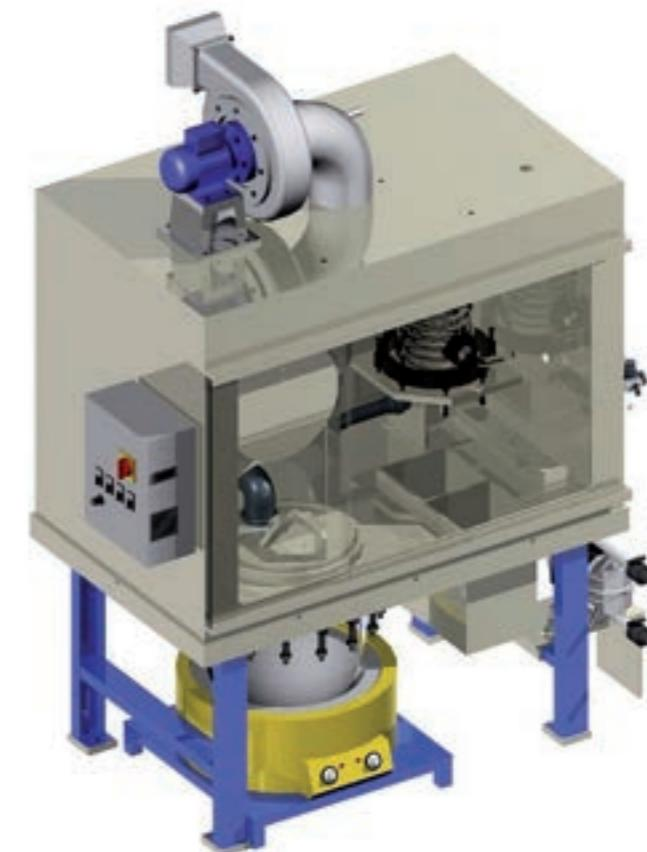
**EUROTechnic**'i iç boşaltma sistemi, çap çok küçük olsa bile, ürün içindeki metali kolayca içi boş zincirler halinde çözebilir. Kullanılabilen metaller demir ve bakırdır. Zincir, hareketli döner bir cihazla hareket ettirilir. Atıkları ve kirliliği önlemek için duman ve yoğunlaşma, cam soğutmalı plastik toplayıcıda emilir.
