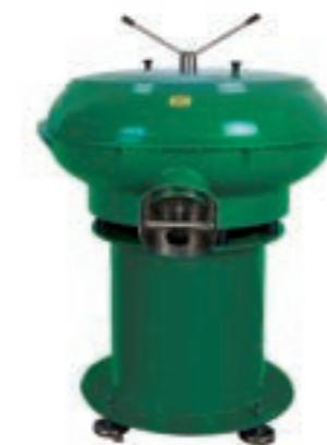
EUROTechnic'in dairesel bilya dolapları, düzleştirme, cıtalama ve ön kaplama işlemlerini gerçekleştirmek üzere tasarlanmış cihazlardır. Titreşimin elektronik olarak değiştirilmesi sistemi, bu makineleri kuyumculuk ve gümüşçülük, mücevher ve gözlük gibi farklı sektörler için uygun hale getirir.
