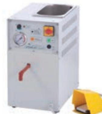
EUROTechnic'in istim makinesi E5003, ucuz, kompakt ve kullanımı kolaydır. Kazan içindeki su seviyesini kontrol eden, minimum seviyeye ulaşıldığında istim otomatik olarak kesen özel bir sistem ile donatılmıştır ve yanın kırmızı ışık, operatöre kazanı makinenin üst kısmındaki musluktan manuel olarak doldurması konusunda uyarıda bulunur. İstim makinalarımız 6 bar basınçta, kesinlikle "nem içermeyen buhar" üretebilmektedir.
